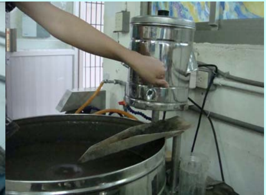
3. 把水流控制成滴 的，避免研磨機上太 水，研磨時易噴。
