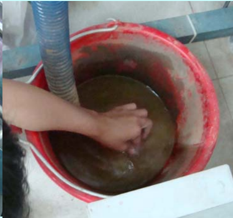
8 到排金剛砂的水桶裡，把玻璃上和手上的金剛砂洗掉。
